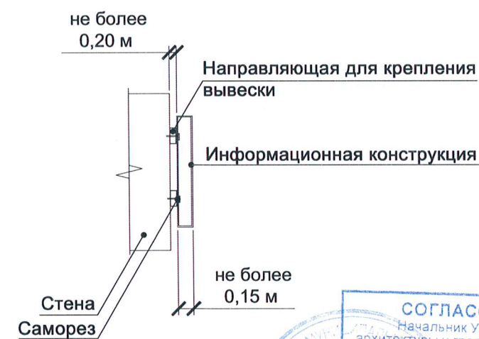
Схема крепления информационных конструкций (поз. 1)
